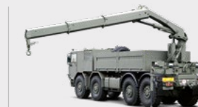
Hydraulické nakládací jeřáby s nízko-zástavbovou výškou HIAB 2222 ATF2
